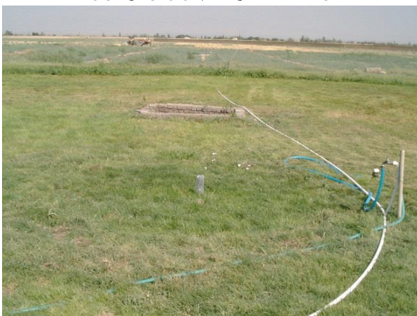
Figure 3- Grass lysimeter with FDR access tube شکل ۳- لایسیمتر چمن و لوله اندازه گیری رطوبت در وسط آن در سال اول و قبل از کاشت برای مدیریت مناسب
