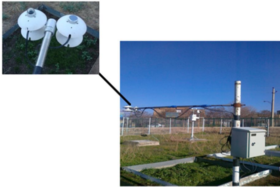
شکل ۲- نمایی از دستگاه واقعه‌نگار تابش خالص واقع در ایستگاه اقلیم‌شناسی دانشگاه بوعلی سینا
