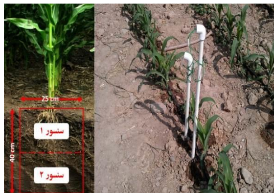
شکل ۱- نمایی از نحوه جانمایی حسگرها
