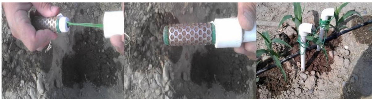
شکل ۳- نحوه نصب حسگرهای واترمارک
